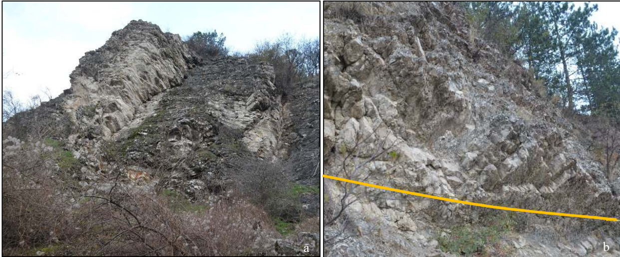
Şekil 3. a) Kireçtaşındaki süreksizlik düzlemlerinin genel b) eklemli kaya kütlelerinin yakından görünümü
